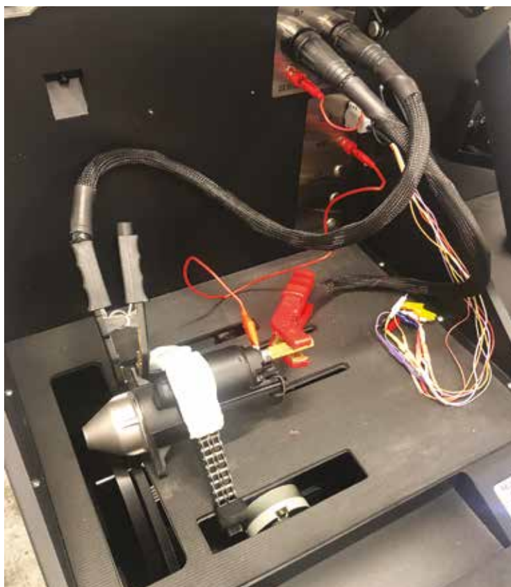
18 Az indítómotor elhelyezése a munkatérben, a vezetékek csatlakoztatása
